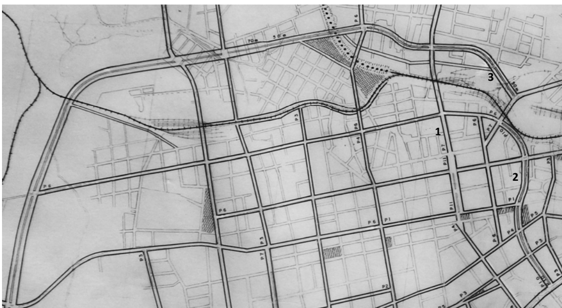
Figura 153: ampliação de parte da prancha nº 16 do plano de 1969 com o sistema viário proposto para Santa Maria. A via identificada com o nº 1 é a Av. Rio Branco; a de nº 2, a Av. Itaimbé; a de nº 3 seria a continuação dessa avenida conforme o projeto de Brito, porém o traçado foi alterado. Acervo do Escritório da Cidade.
