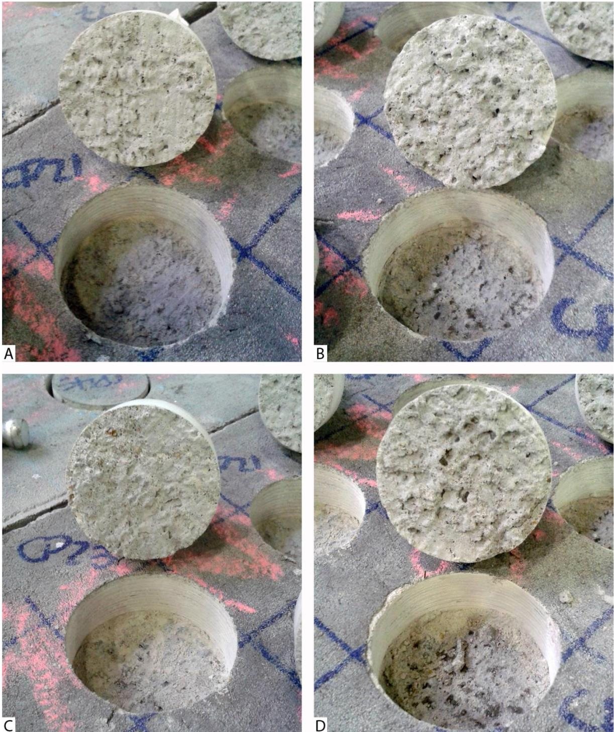
Quanto os corpos-de-prova das amostras com textura Líquen 87,5% (figura 36) e 62,5% (figura 37) na interface concreto/argamassa de revestimento, alguns rompimentos se deram 100% na interface dos substratos, mostrando os valores entendidos como iguais a verdadeira resistência de aderência à tração. Porém, resultados como aqueles atribuídos aos corpos-de-prova CP25, CP33, CP38, CP40,
