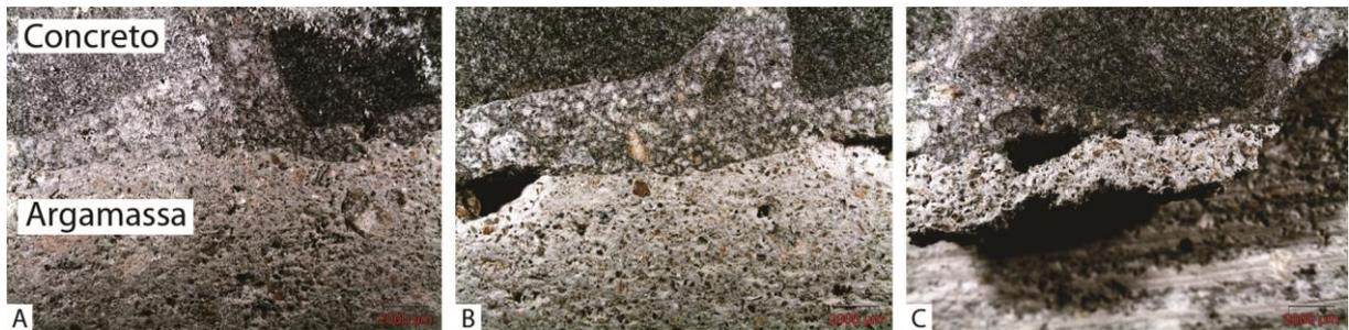
Figura 41: imagens adquiridas através de equipamento microscópio estereoscópio. Amostra com a textura Líquen 62,5% gravada na superfície do substrato de concreto. Aumento 0.7x com barra de escala fixada em 2000µm.
