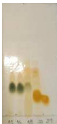
Figura. 3. Cromatografia em camada delgada, fase móvel hexano:acetato de etila (9:1) das frações obtidas por cromatografia em coluna.
