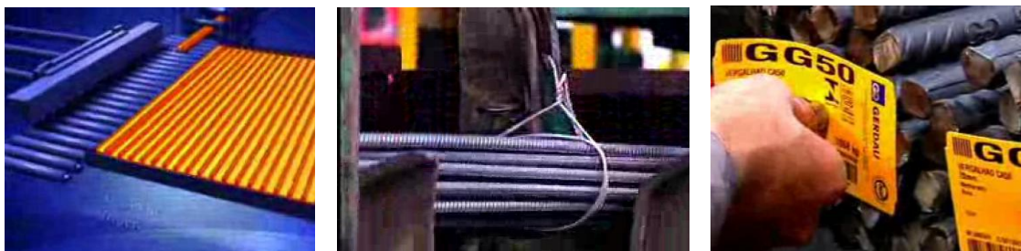
Figura 71: Lecho de refrigeración (Gerdau Laisa) Figura 72: Embalaje (Gerdau Laisa) Figura 73: Almacenamiento (Gerdau Laisa)
