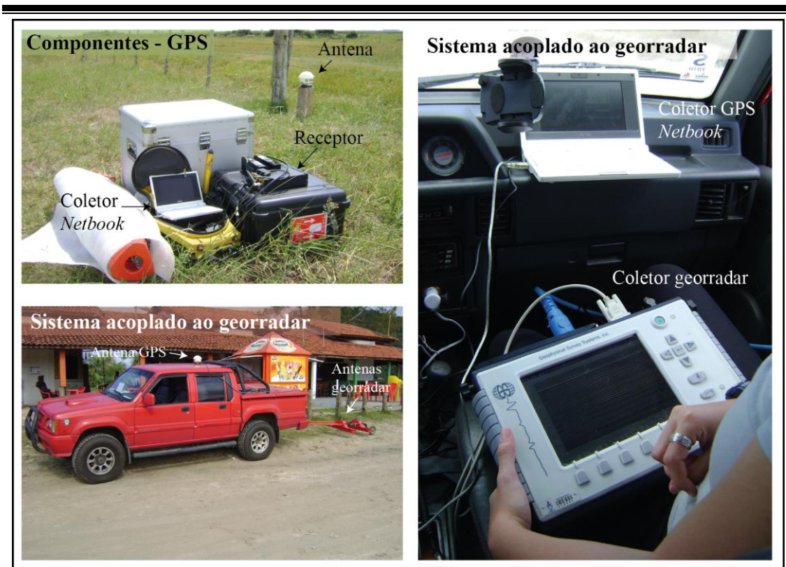
Figura 39. Ilustração do sistema de posicionamento utilizado, composto pela antena, pelo receptor, pelo coletor e pelos cabos para conexão. A antena do GPS foi posicionada no topo do veículo de campo e o sistema foi conectado ao coletor do georradar para o posicionamento das seções.
