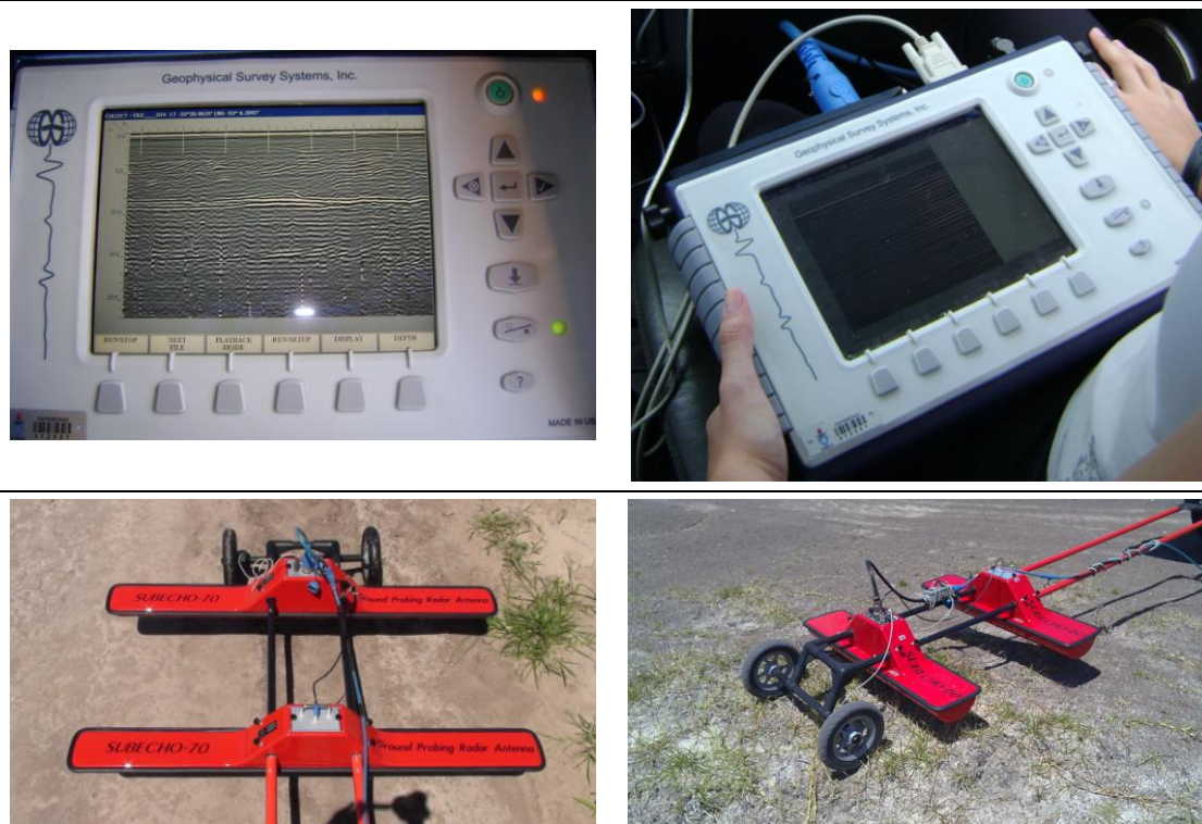
Figura 45. Equipamento de georradar utilizado. No topo, fotografia do coletor SIR3000 da GSSI. Na base, antenas aéreas com frequência central de 70 (à esquerda) e 150 MHz (à direita).
