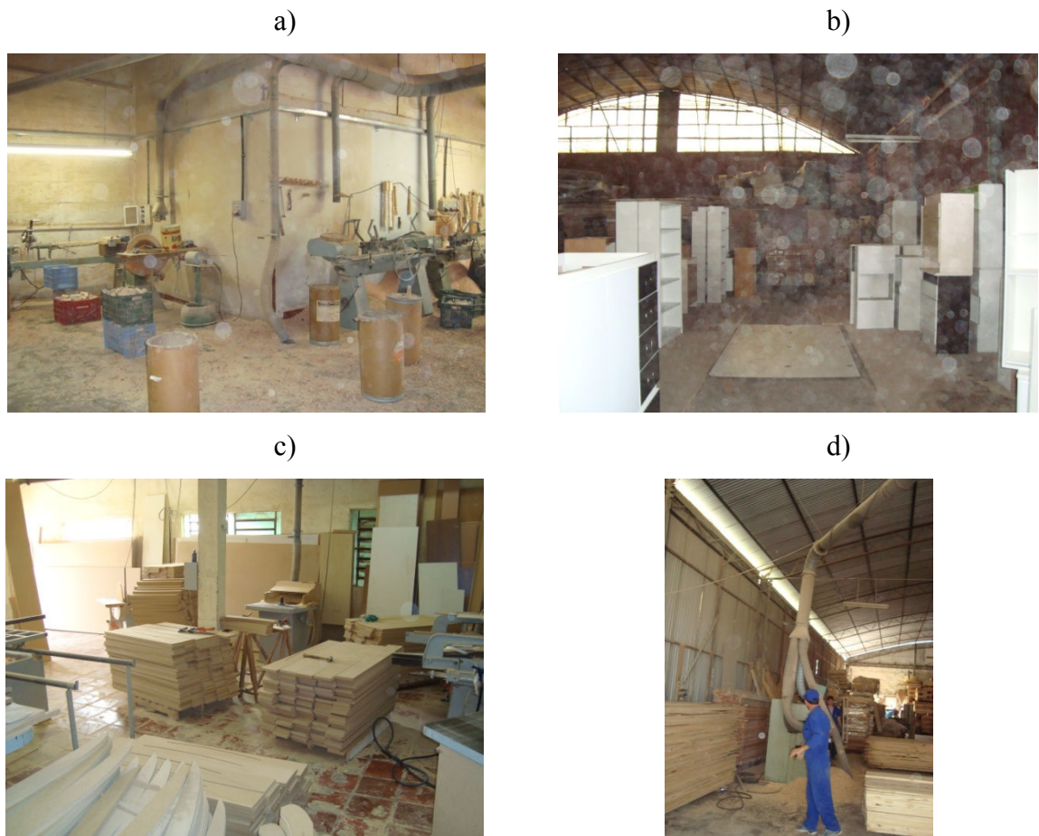
Figura 47. Exemplos de sistema de exaustão ineficientes: a e b) com material particulado no ar, c e d) no chão. Fotos da autora.
