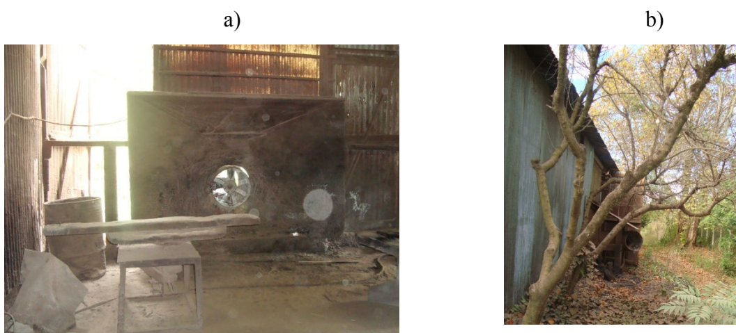
Figura 44. Exemplos de cabines de pintura ineficientes: a) cabine apresentada, b) emissões fugitivas. Fotos da autora.
