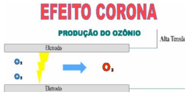
Figura 2. Esquema de formação de gás ozônio – efeito corona. (ELETRICIDADE, 2011)
