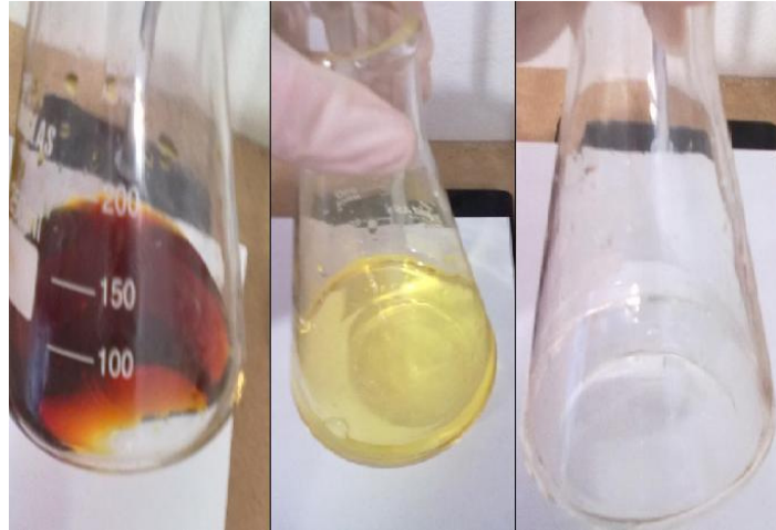
Figura 6. Titulação iodométrica para a determinação da quantidade de ozônio absorvida pela solução de iodeto de potássio.
