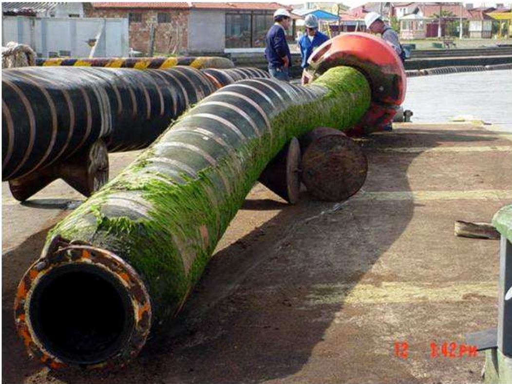
Figura 1.2– Imagem da seção de um mangote transportador de petróleo. Fonte: LAMEF.
