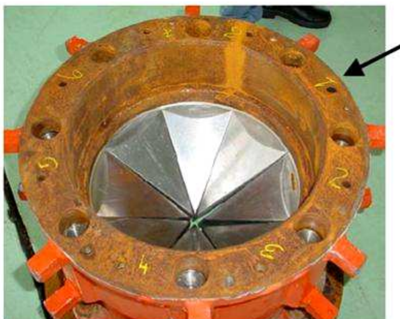
Figura 1.3– Sistema Double Closure Marine Breakaway Coupling . A seta indica onde o pino é fixado. Fonte: LAMEF.
