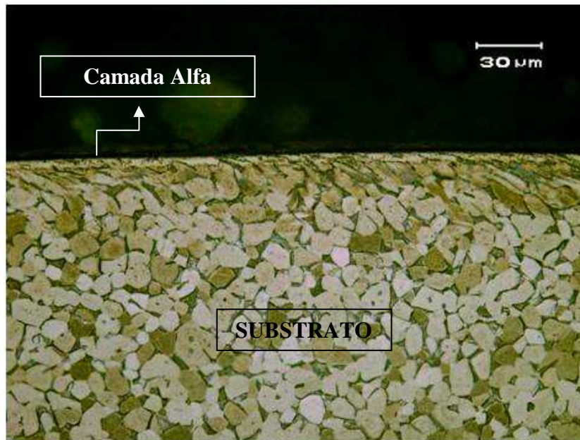
Figura 4.8 – Camada alfa decorrente da oxidação térmica para Rota 3. Reagente Kroll – Magnificação 500x.
