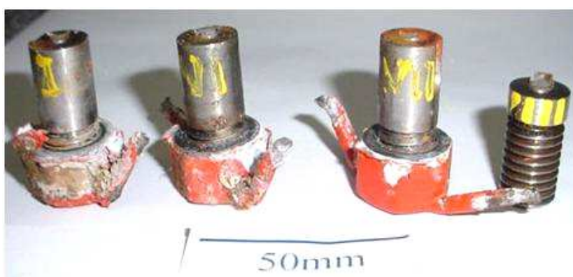
Figura 1.4– Pinos fusíveis mecânicos fraturados em serviço. Fonte: LAMEF.
