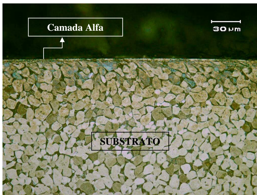
Figura 4.7 – Camada alfa decorrente da oxidação térmica para Rota 2. Reagente Kroll – Magnificação 500x.
