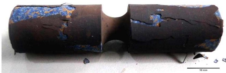
Figura 4.1 – Óxido dissociado para o pino oxidado termicamente através da Rota 4.
