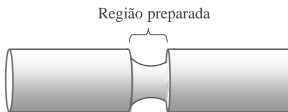
Figura 3.4 – Desenho esquemático de um corpo-de-prova (pino fusível mecânico), mostrando o local onde o material foi preparado.
