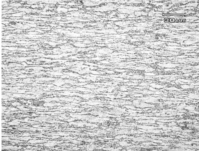
Figura 4.4 – Microestrutura da seção longitudinal do material como obtido. Magnificação 500x.
