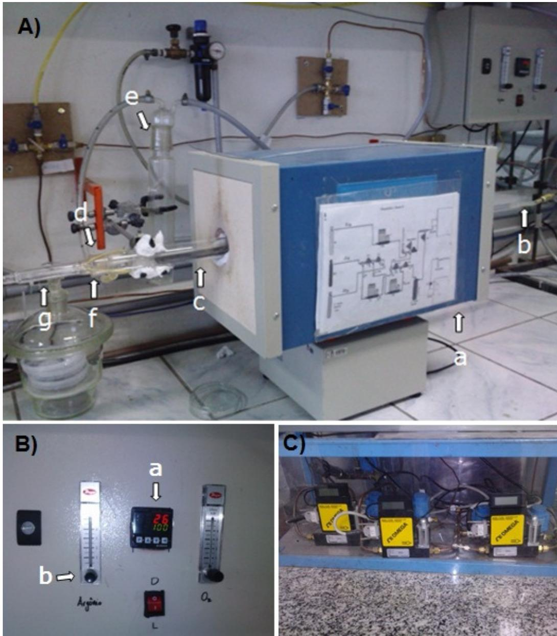
**Figura 5.2 - (A)** Reator de CCVD de leito horizontal onde **a** é o forno elétrico, **b** a entrada de gases, **c** o tubo de quartzo, **d** a saída de gases, **e** o borbulhador da saída dos gases, **f** a abertura para inserção das amostras e **g** a entrada para o termopar no tubo de quartzo; **(B)** Painel de controle manual onde **a** é o controlador de temperatura do forno e **b** o fluxômetro digital para o fluxo de argônio externo; **(C)** Fluxômetros digitais.
