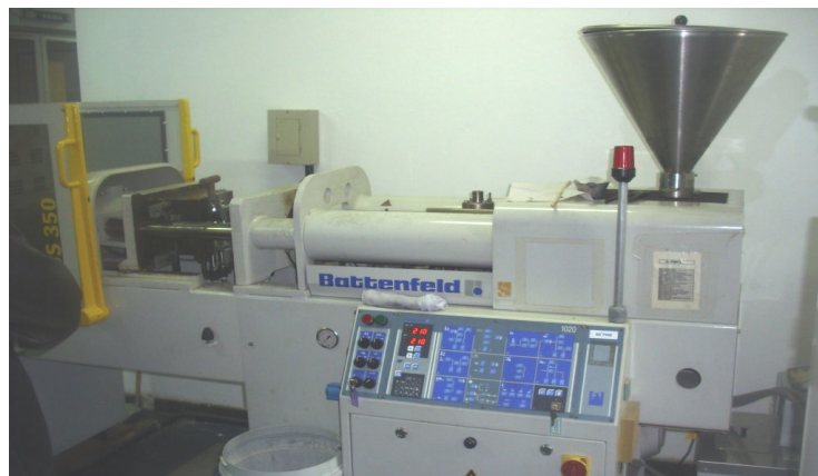
Figura 12: Injetora utilizada na produção dos corpos de prova
