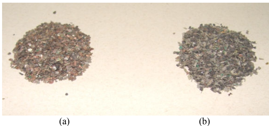
Figura 21: Frações obtidas após separação eletrostática - (a) Condutora e (b) Não Condutora
