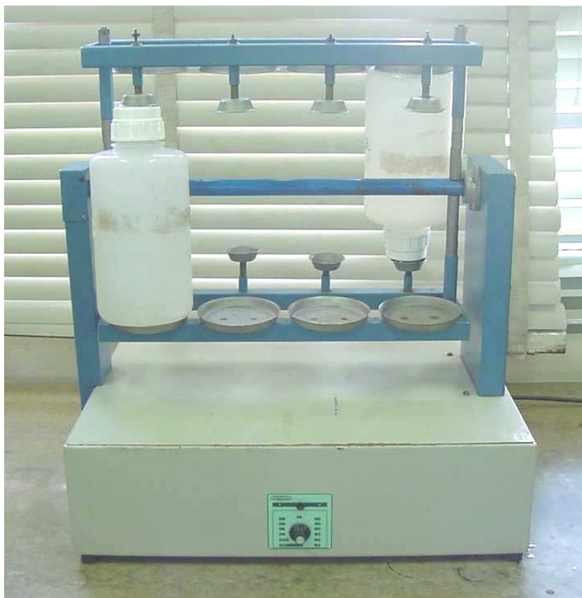
Figura 5: Agitador de wagner e frascos utilizados no ensaio de lixiviação
