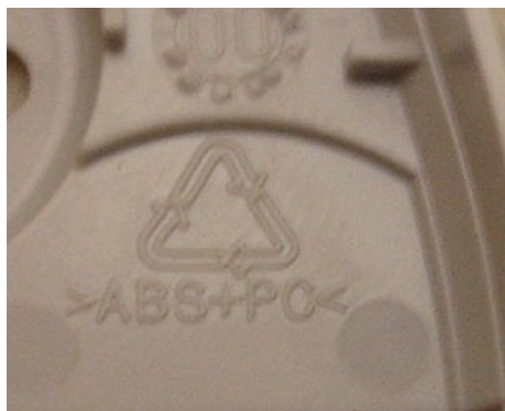
Figura 11: Identificação através dos símbolos gravados nas carcaças
