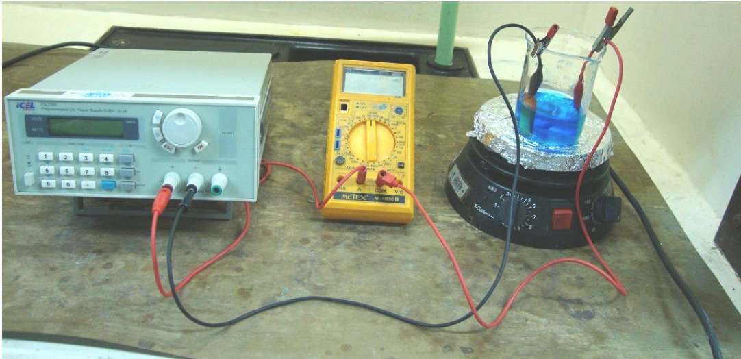
Figura 10: Célula montada para a eletrodeposição
