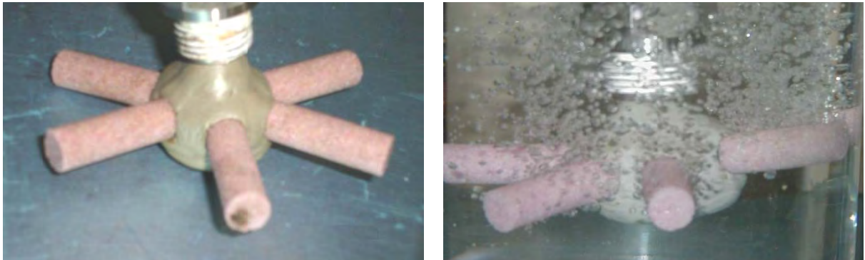
Figura 3.5: Fotografias do aerador utilizado para o sistema de MBR.
