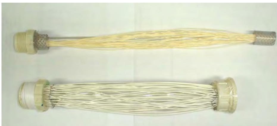
Figura 4.10: Fotos dos módulos obtidos por duas técnicas de colagem diferentes.
