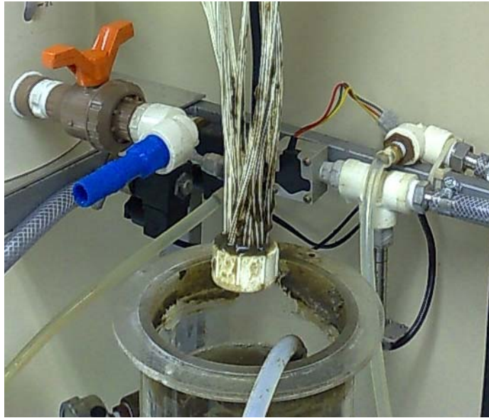
Figura 4.15: Fotografia do feixe de membranas apresentando acúmulo de lodo na parte inferior do feixe.
