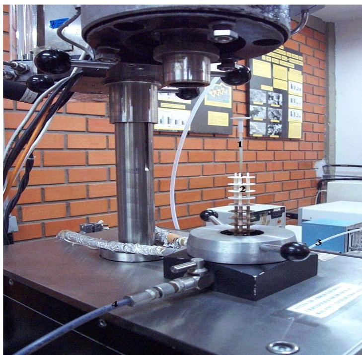
Figura 18 - Principais componentes da termobalança. 1- Termopar, 2- Anéis protetores de radiação, 3- Entrada de gases, 4-Saída de gases provenientes da câmara de reação e da balança analítica
