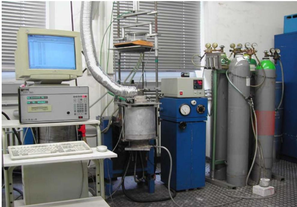
Figura 20 – Foto do experimental utilizado nos testes com forno Tamman
