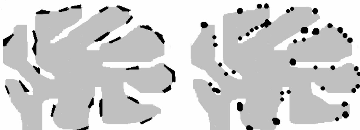
Figura 52 – Mecanismo simples que ilustra o bloqueio completo ou parcial dos poros do char durante a gaseificação (1) temperatura abaixo do ponto de fusão, (2) temperatura acima do ponto de fusão
