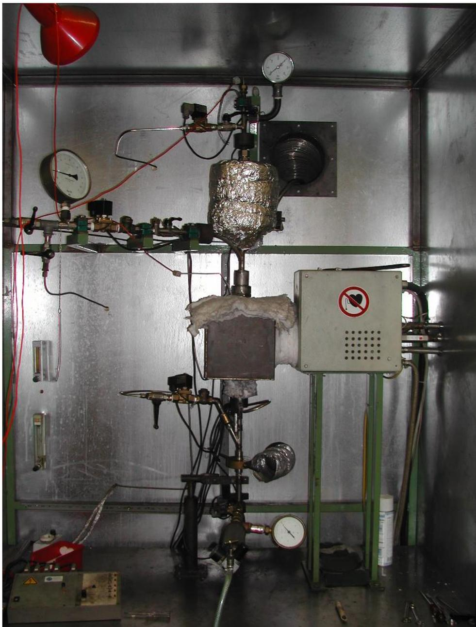
Figura 23 - Foto do simulador da zona de combustão utilizado nos experimentos
