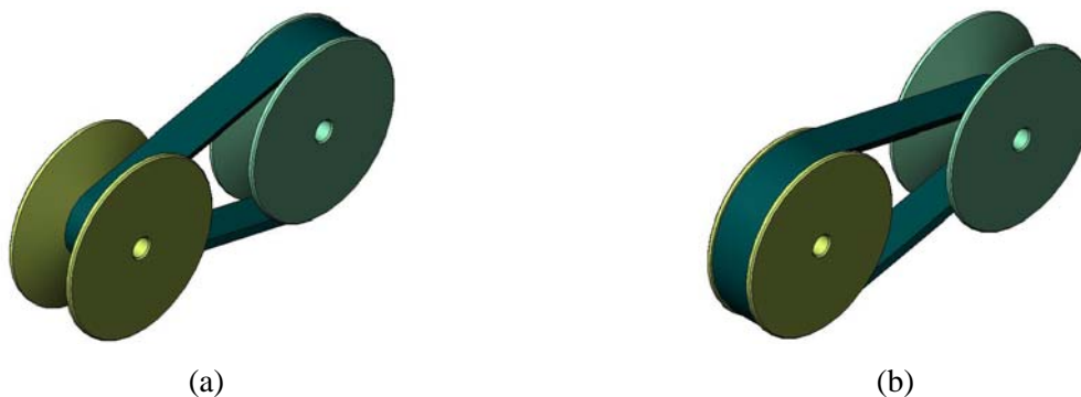
Figura 2.6 – CVT por polias variadoras ou expansivas: a) redução da velocidade e b) ampliação da velocidade.
