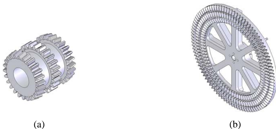
Figura 3.9 – Engrenagens da transmissão proposta: a) pinhão e b) coroa.
