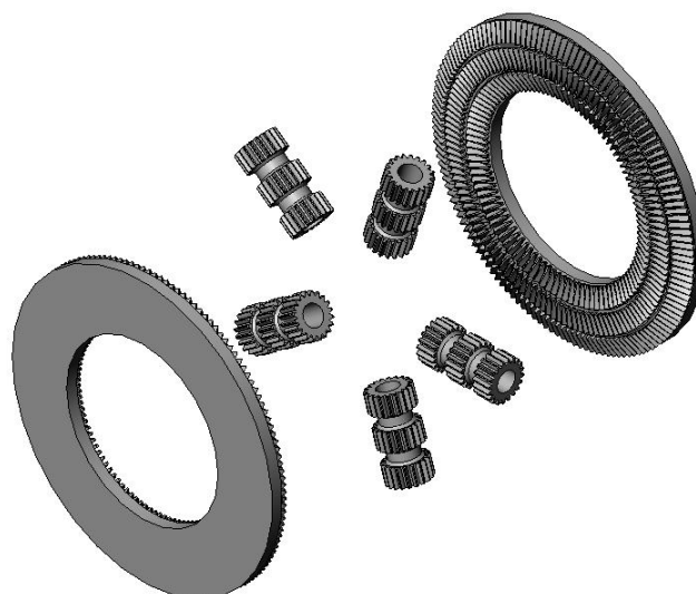
Figura F.2 – Aspecto final das coroas e pinhões para a transmissão a ser aplicada no trator.
