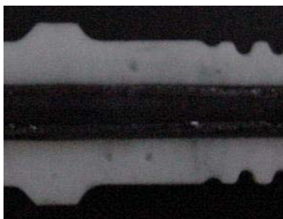
Figura 65: Poros na parte cerâmica da vela NST. Fonte: (Guimaraens, 2005).
