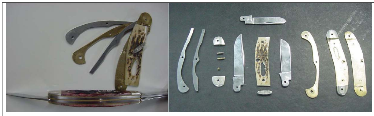
Figura 42: Canivete montado e desmontado. Fonte: (Holz, 2005).
