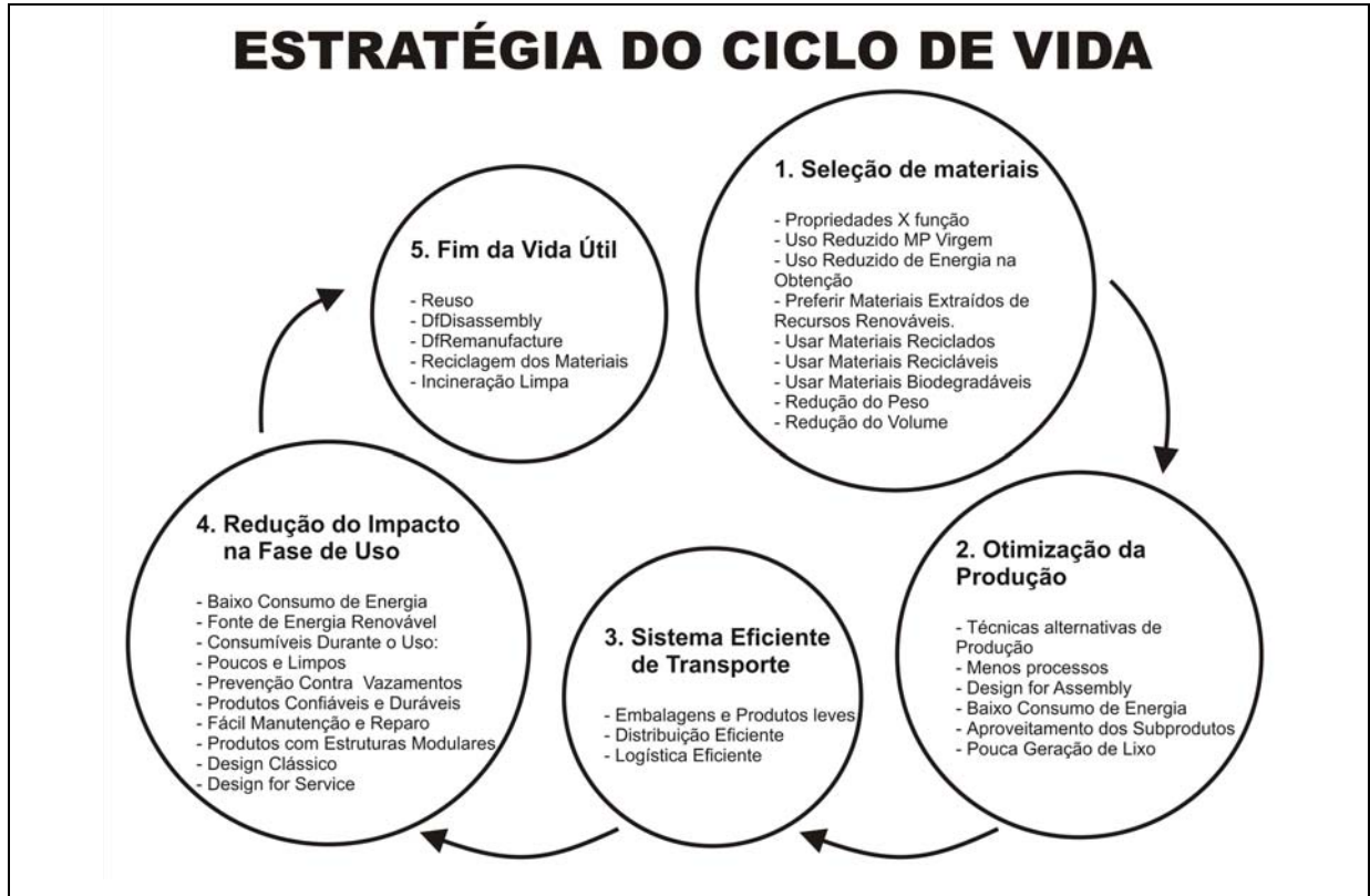
Figura 10: Estratégias do Ciclo de Vida de um produto. Figura adaptada de Gobbi (2006).
