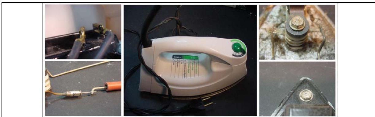
Figura 19: Alguns elementos de junção encontrados no Ferro de passar roupa. Fonte: Kindlein (2006b).
