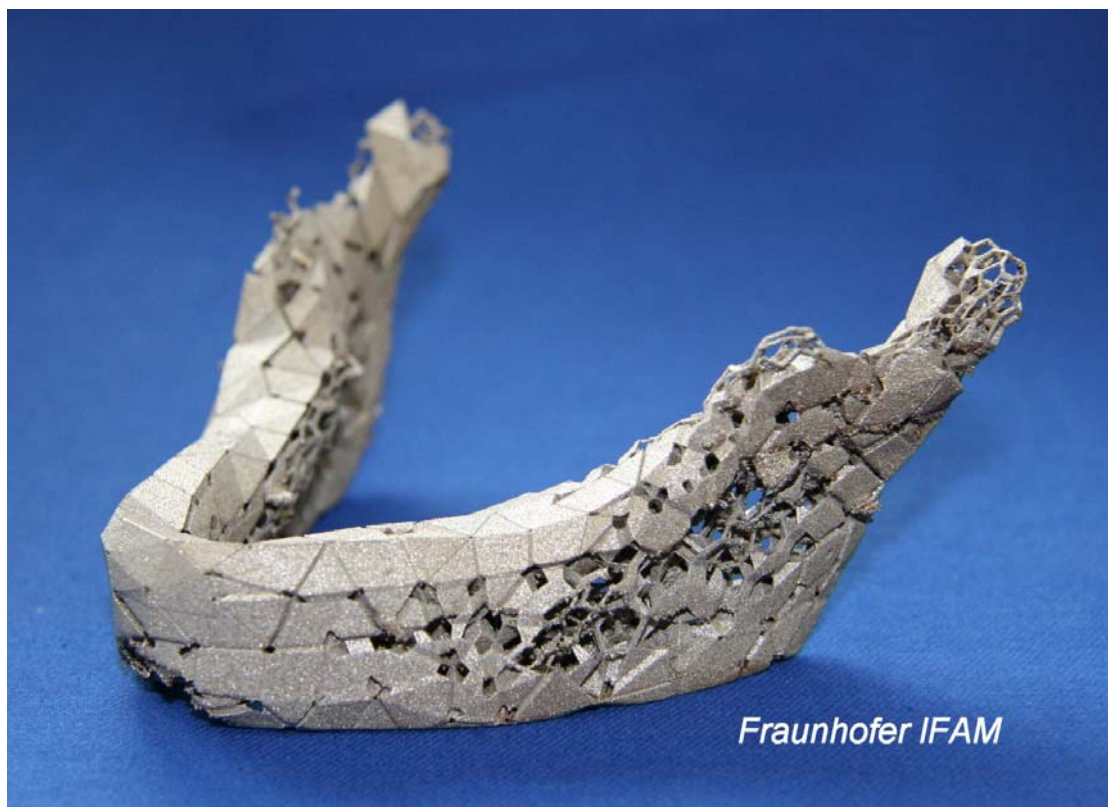
Figura 68 - Modelo obtido pelo método MPTO, fabricado em Ti-6Al-4V por sinterização a laser.
