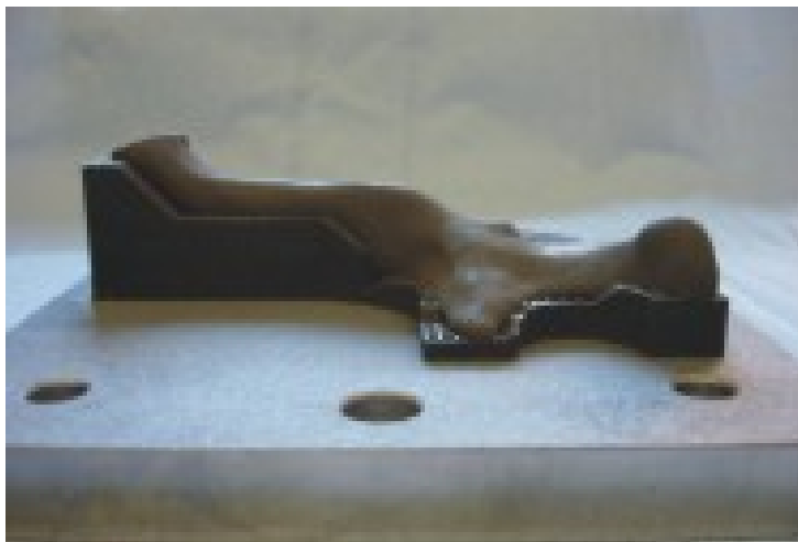
Figura 51 - Modelo de mandíbula e estruturas suporte confeccionados pelo processo de DMLS.
