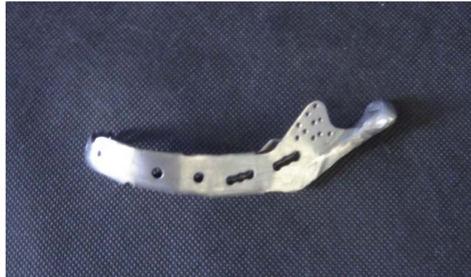
Figura 45 - Estrutura metálica produzida em titânio pelos processos de conformação mecânica, usinagem e soldagem.
