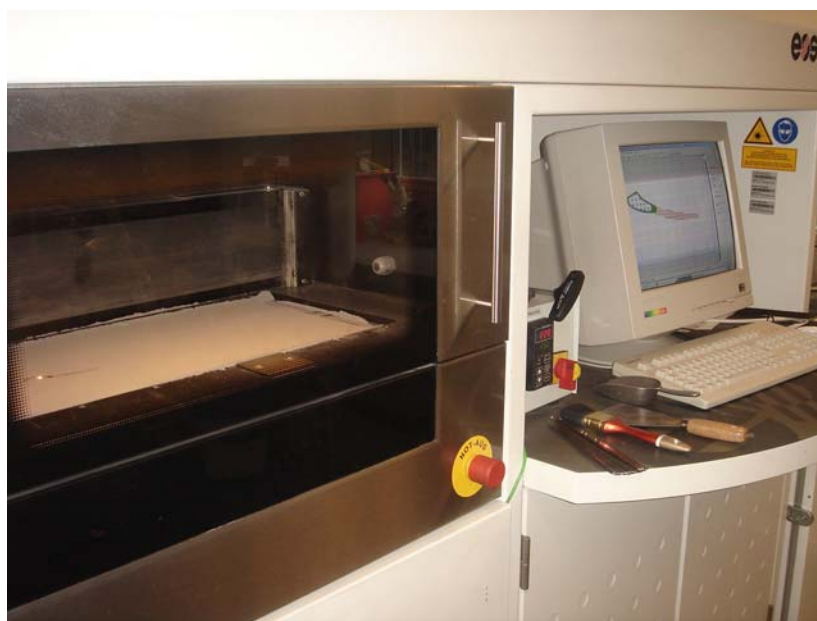
Figura 26 - Equipamento de sinterização a laser modelo EOSINT M 250X. Fonte: Equipamento instalado nas dependências do Instituto Fraunhofer IFAM, Alemanha.
