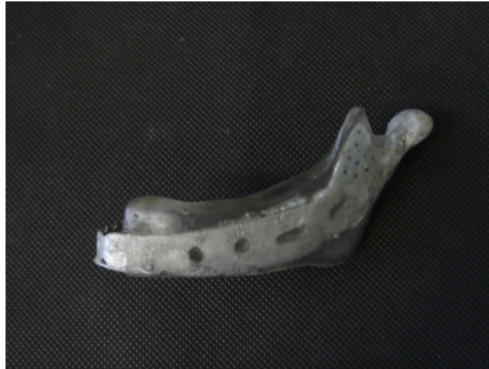
Figura 41 - Protótipo da prótese de mandíbula constituído de estrutura metálica, resina epóxi e resina poliéster.
