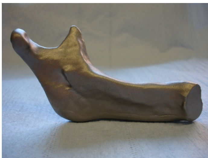
Figura 58 - Modelo físico produzido por sinterização a laser, baseado em dados de tomografia computadorizada.
