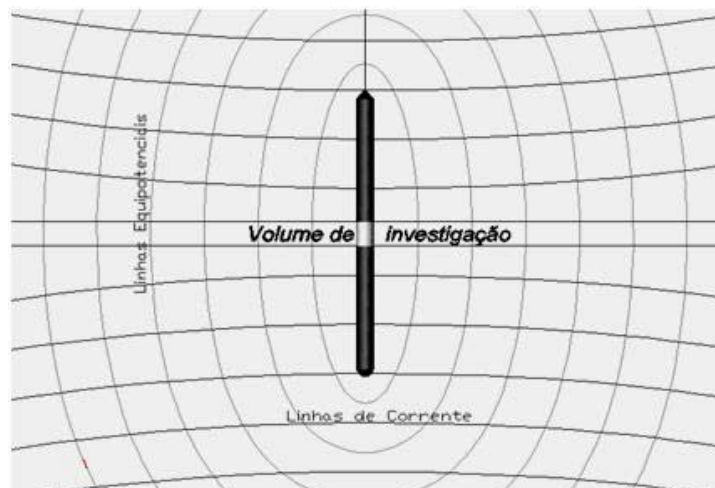
Figura 2.12: Linhas equipotenciais e de corrente em sondas para medir a resistividade com focalizadores (Oliveira, 2005).
