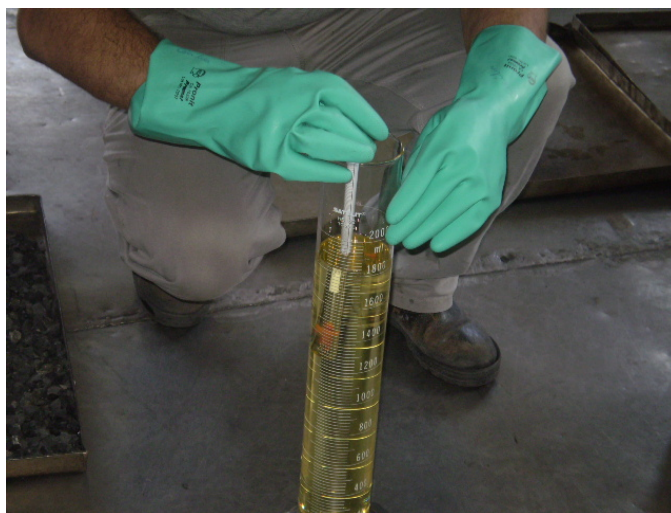
Figura 4.17: Preparação de um meio denso com Bromofórmio.
