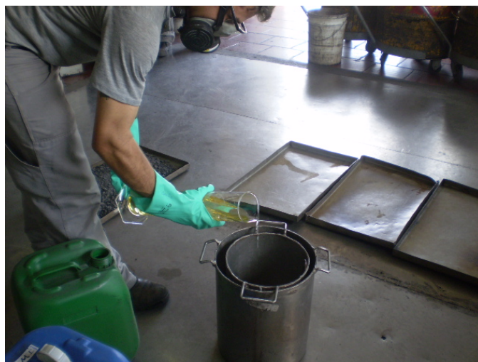
Figura 4.18: Meio denso sendo despejado na cuba.
