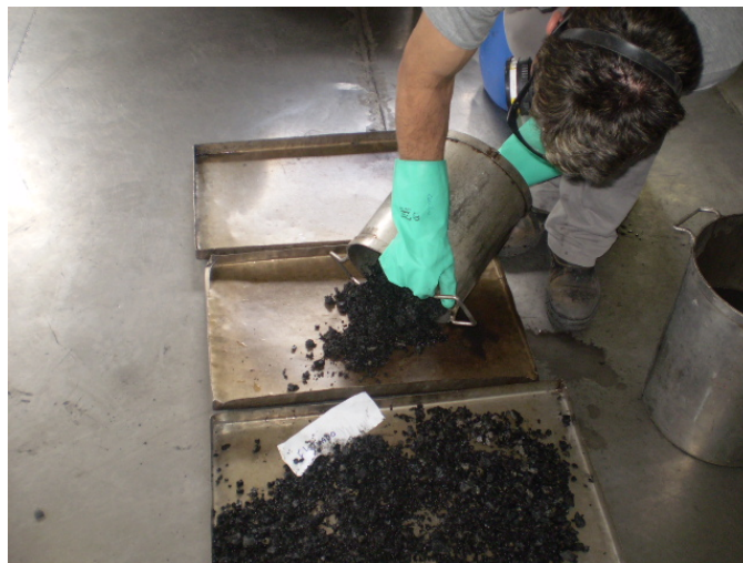
Figura 4.20: Material afundado coletado com ajuda de um cesto.
