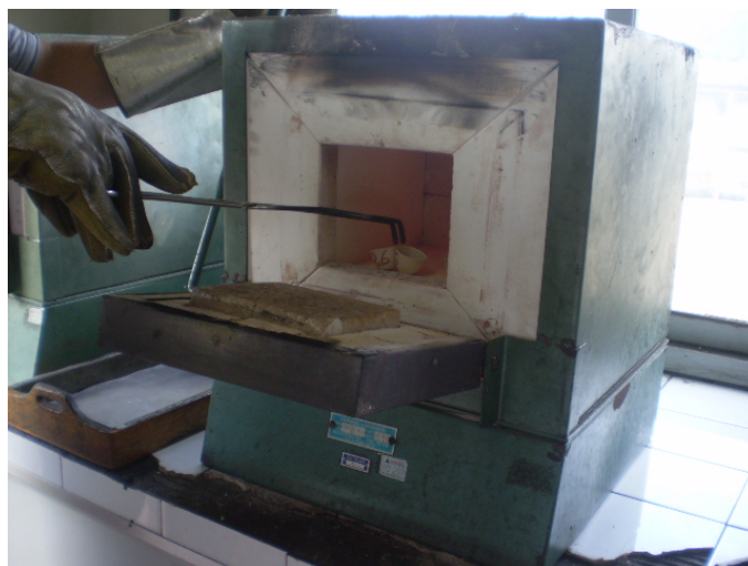
Figura 4.22: Cadinhos contendo as amostras sendo inseridos no forno de mufla.
