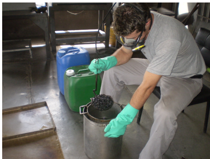
Figura 4.19: Coleta do material flutuado com ajuda de uma concha.
