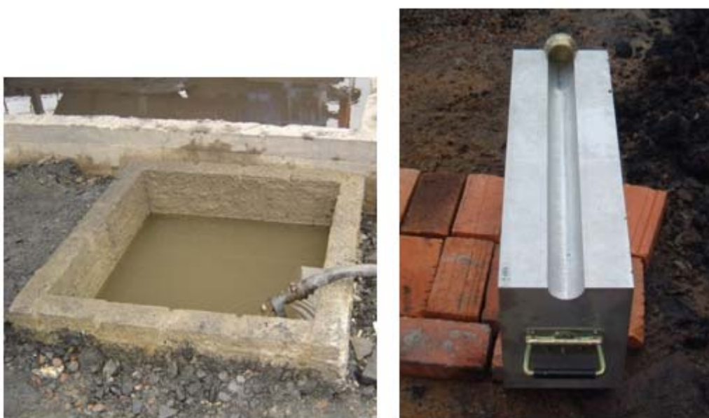
Figura 4.34: Fotos dos pontos de calibração, cuba com água à esquerda e bloco de alumínio a direita.
