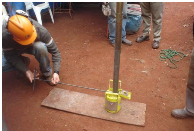
Figura 4.13: Acoplamento da fonte radioativa na sonda SWDS®.
