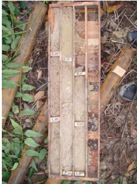
Figura 4.7: Recuperação de testemunho de sondagem disposto na caixa.
