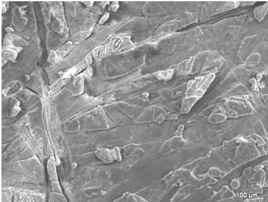
Figura 95- Micrografia da membrana Nafion 450 depois de 30 dias imersa no banho de cromo contaminado com alumínio.
