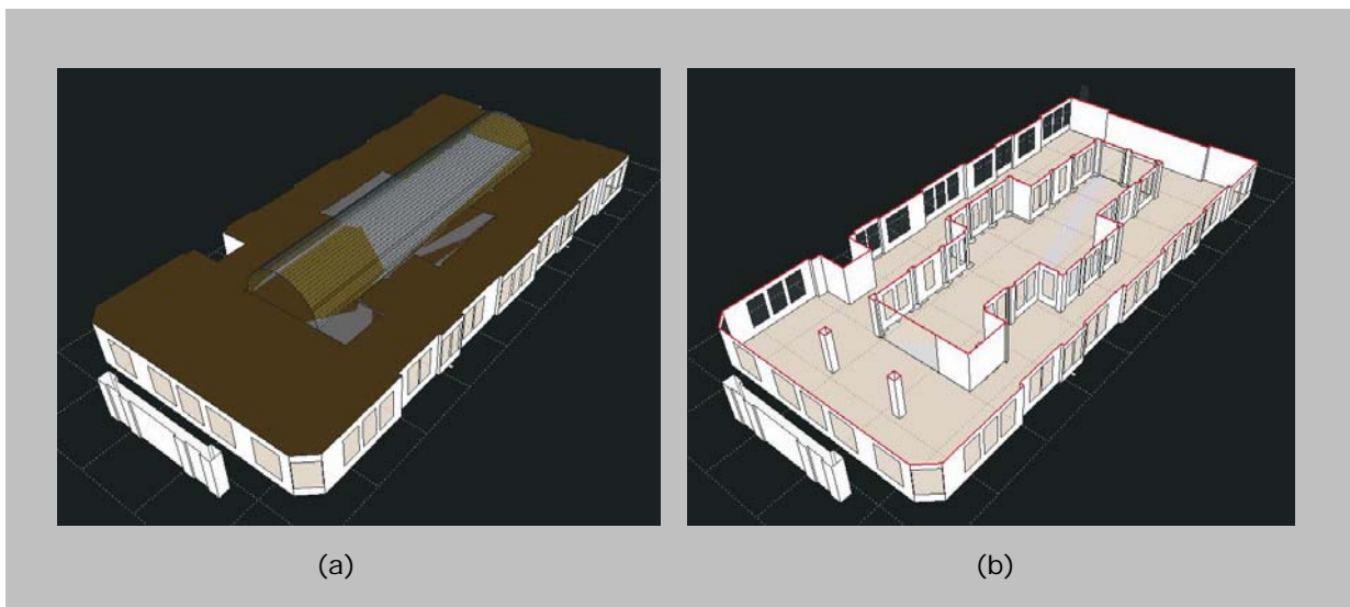
FIGURA 4.13 - MODELO PARA SIMULAÇÃO DA PLANTA DO 2º PAVIMENTO COM A COBERTURA (a) E EM PLANTA (b)
