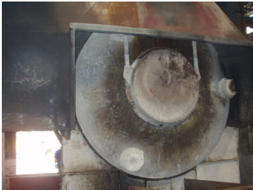
Figura 20: Forno rotativo com capacidade para 12 t
