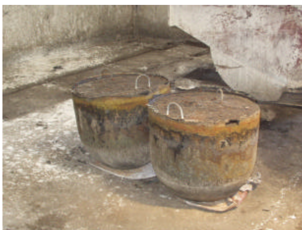
Figura 60: Copos de escória solidificada após a etapa de vazamento
