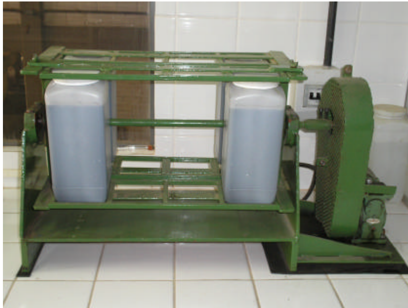
Figura 19: Agitador rotativo utilizado para os ensaios de lixiviação
