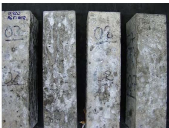
Figura 133: Vista geral dos prismas de concreto de referência com espalhamento de eflorescências brancas na superfície - 12 meses.
