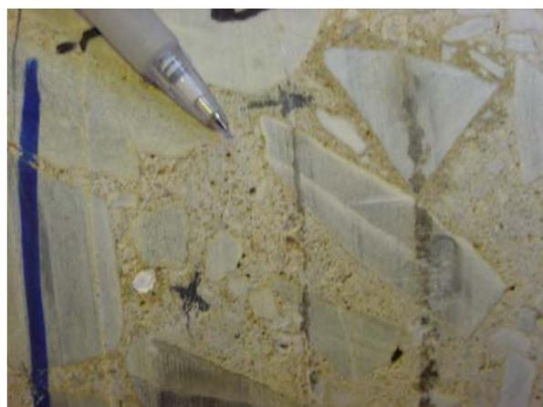
Figura 35: Poro com deposição branca (C0-B5-15).
