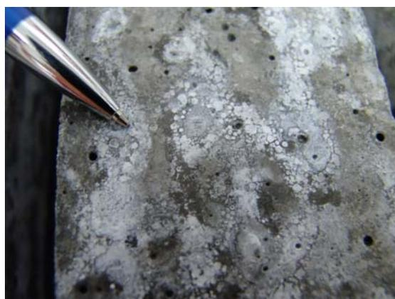
Figura 134: Detalhe mais ampliado de um dos prismas mostrando a abrangência dos sintomas na amostra de referência aos 12 meses.
