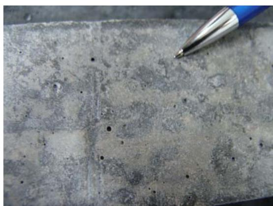
Figura 136: Detalhe mais ampliado mostrando algum manchamento e pontos brancos, quase imperceptíveis, espalhados no concreto tratado com lítio - 12 meses.
