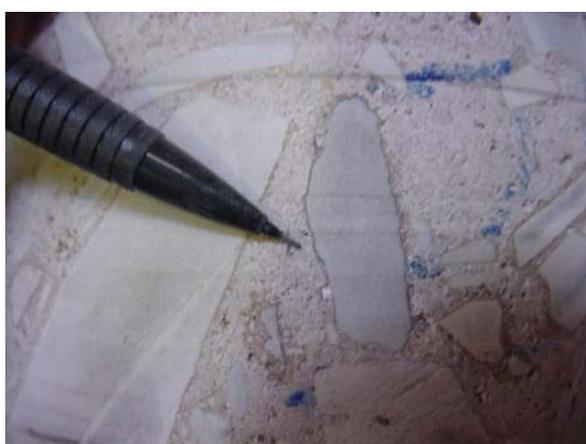
Figura 38: Mancha e borda de reação (C1-B3-30A).
