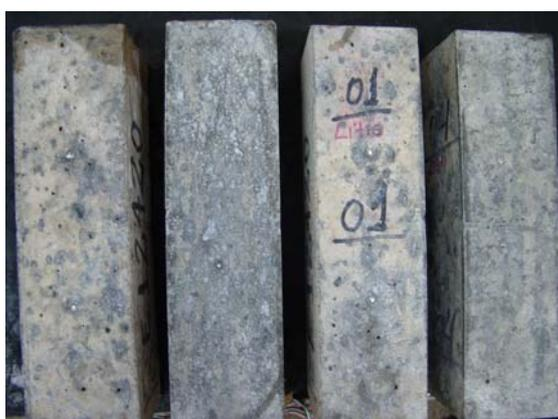
Figura 135: Vista geral dos prismas de concreto tratados com lítio aos 12 meses indicando uma menor deterioração visual.
