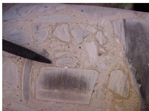
Figura 39: Poro com deposição branca e mancha (C1-B4-50A).
