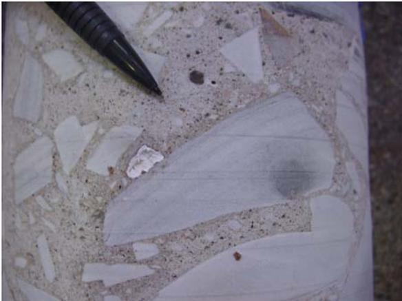
Figura 42: Poro branco próximo ao agregado C2-B1-28).
