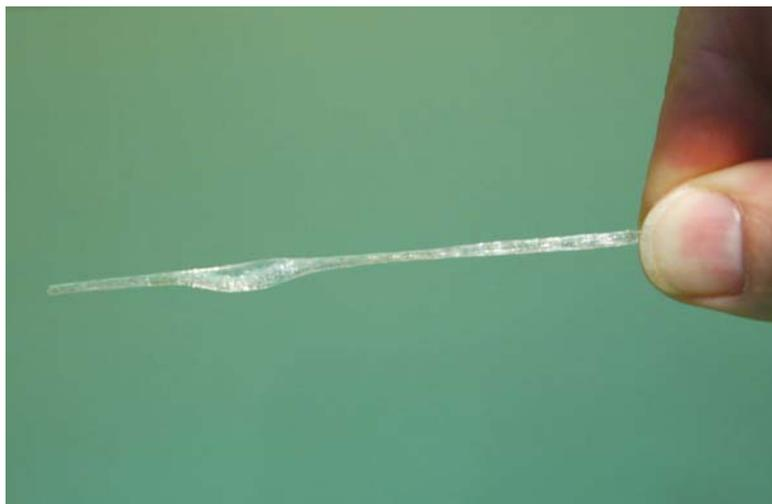
Figura 157: Detalhe de uma amostra de gel estirada a temperaturas acima de 1000°C.
