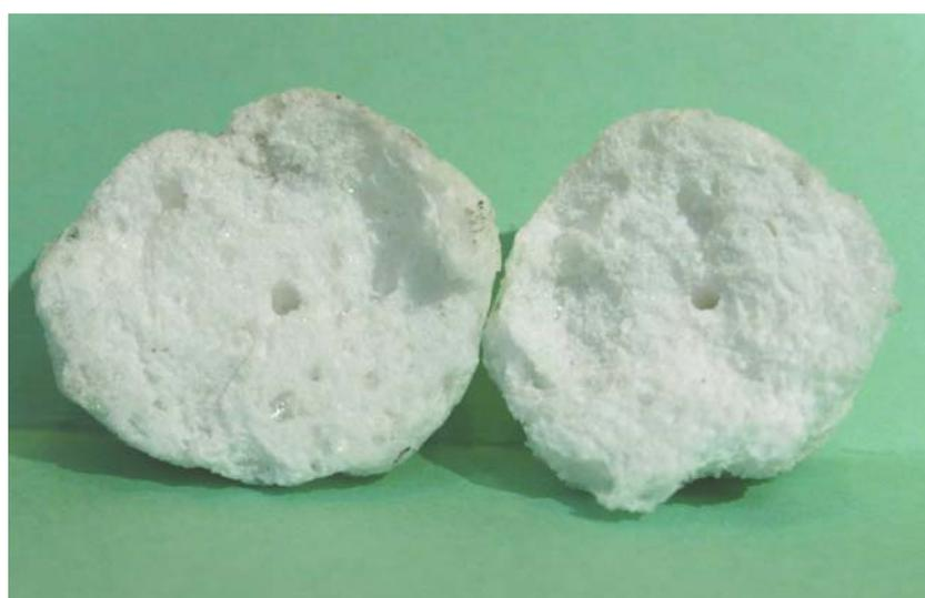
Figura 156: Porção interna da amostra de gel A após exposição a 500°C.
