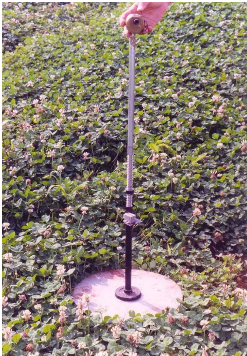
Figura 4 – Avaliação da massa de forragem com o disco medidor.
