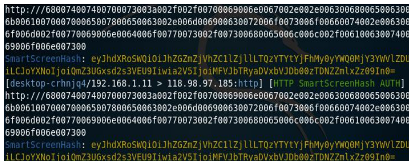
Gambar 5. Hasil pengujian HTTPS dengan menggunakan bettercap
