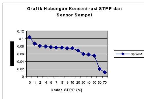
Gambar 9 Grafik Hubungan Konsentrasi STPP Dengan V<sub>out</sub> Sensor Sampel.
