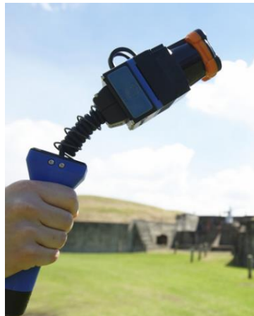
Kuva 11. Kädessä kannettava Zebedee laserskanneri.
