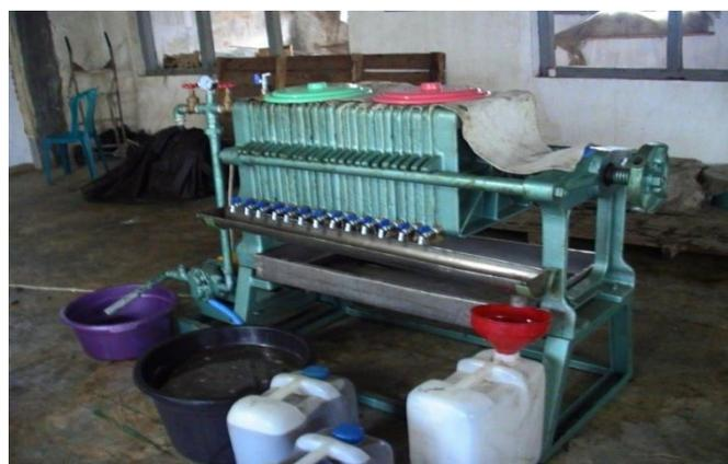
**Gambar 5.** Filter press sebagai penyaring produk biofuel
