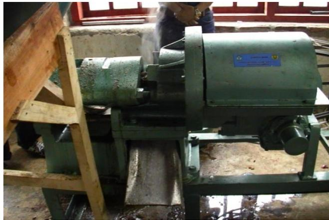
**Gambar 4.** Mesin pemeras minyak (*screw press*)
