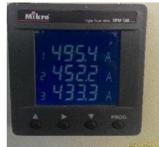
Gambar 14. Tampilan Alat Ukur untuk Nilai Arus per fasa tanggal 20 Juli 2016 pada Pukul 09:00 untuk Fasa I L1
