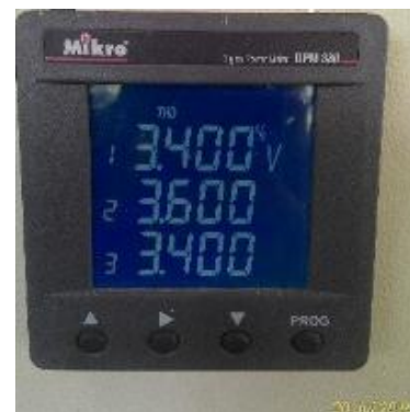
Gambar 8. Tampilan Alat Ukur untuk Nilai Harmonisa Arus dan Harmonisa Tegangan Tanggal 20 Juli 2016 untuk Pukul 11:00 pada Fasa L 1
