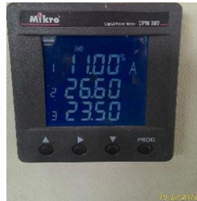
Gambar 4. Tampilan Pengukuran %THDi
