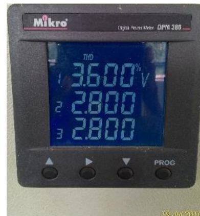
Gambar 5. Tampilan Pengukuran %THDv
