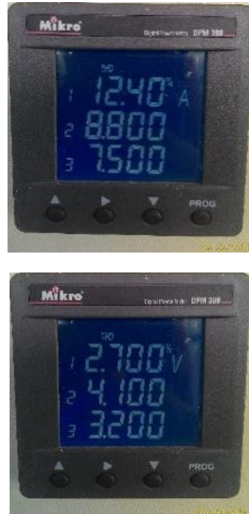
Gambar 12. Tampilan Alat Ukur untuk Nilai Harmonisa Arus dan Harmonisa Tegangan Tanggal 20 Juli 2016 pada Pukul 09:00 untuk Fasa L 3
