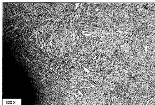
Gambar 9. Optical Micrograph pembesaran 320 kali pada sisi permulaan primary crack
