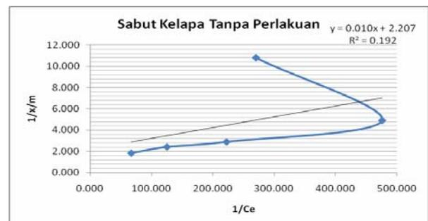
**Gambar 3. Isoterm adsorpsi Langmuir dengan adsorben sabut kelapa tanpa perlakuan**
