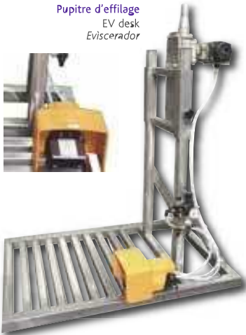
PEMOL Avec coupe du cloaque With vent cutting Con corta del ano
