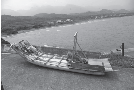
写真6 台湾東海岸で使用される塩ビパイプ筏式漁船
