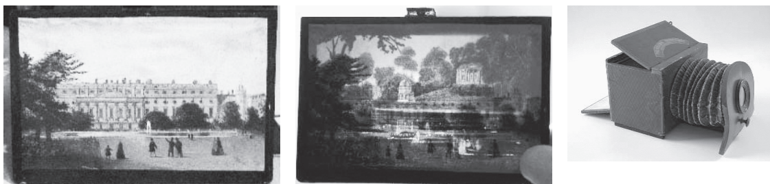
図16 Polyorama panoptique (1855年頃) (Material: wood / paper / glass) 絵は5枚組。蛇腹は紙製。左は昼景(上部採光)、右は夜景(背面透過光)、同じ1枚のボードであるが、全く違う景色が現れる。(レンズ径1.2インチ、全長8.5インチ)
