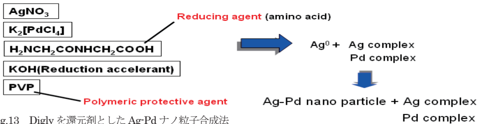
Fig.13 Digly を還元剤とした Ag-Pd ナノ粒子合成法
