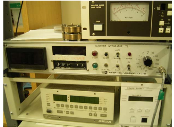
図 8. 真中の細長い計器が高感度電流計である。電流積分計としての機能も備えている。
