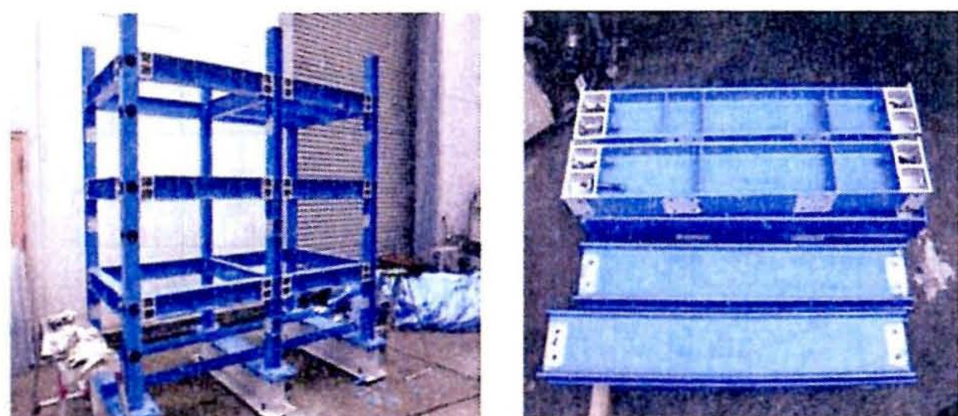
(a) 座屈拘束部材の切除
