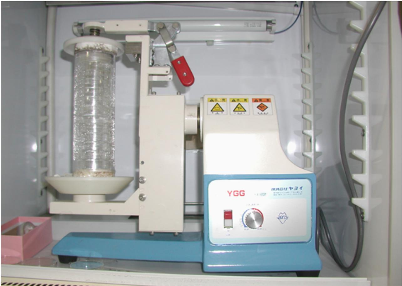
図1. クリノスタット (疑似微小重力装置: YAYOI振盪器 YGG-1型改). 種子を播いたシャーレを回転部に取り付け, 直交する2軸 (公転軸と自転軸) の公転: 自転比を1.0:1.6で回転させることで植物に疑似微小重力環境を与えながら成長させることができる.
