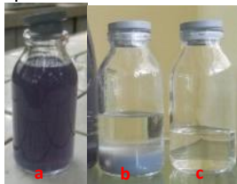
Gambar 1. (a) inlet (b) setelah penambahan NaOH (c) hasil presipitasi
