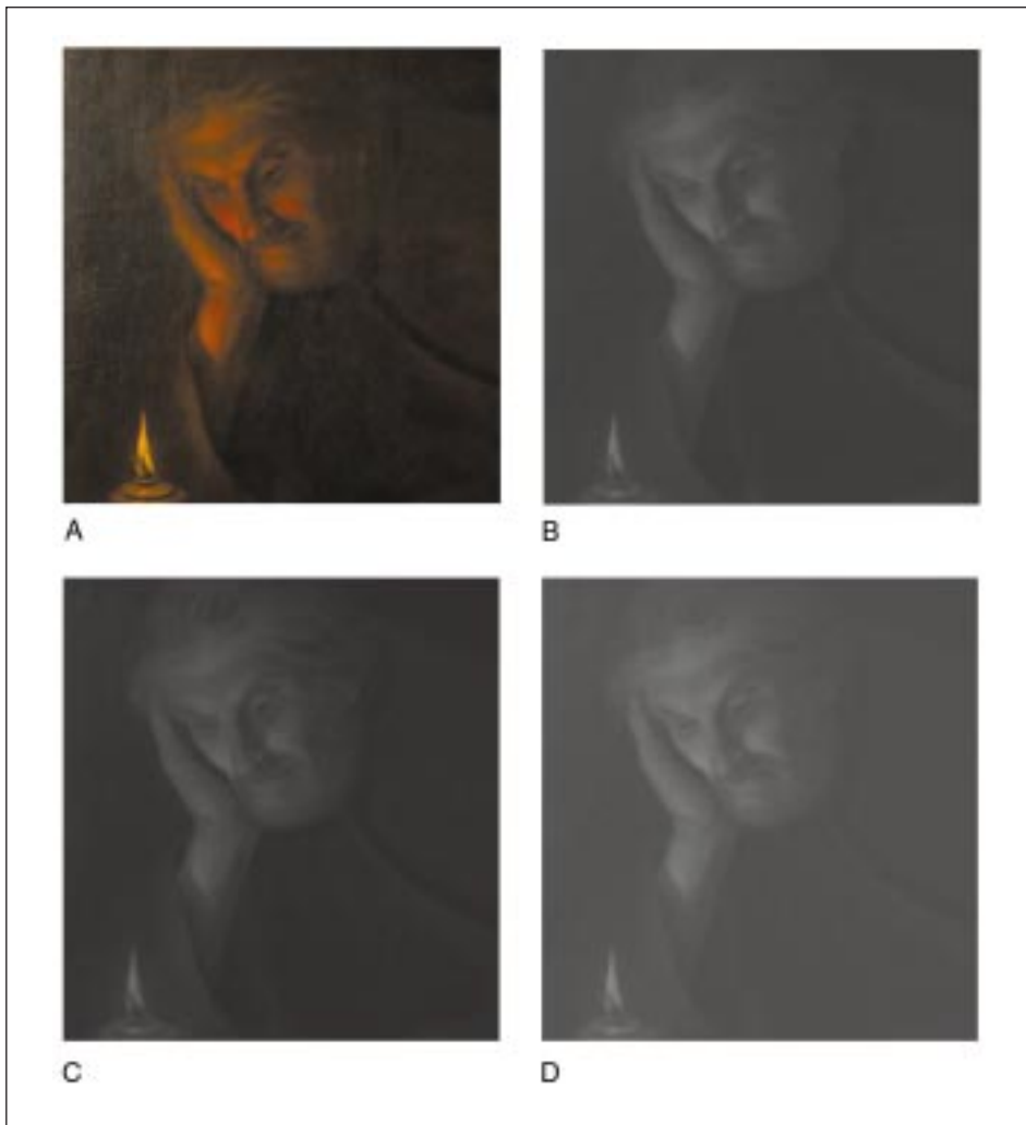
Figura 4. Riflettografia nel visibile (A), in NIR1 (B), in NIR2 (C), in NIR3 (D): visione complessiva della figura.
