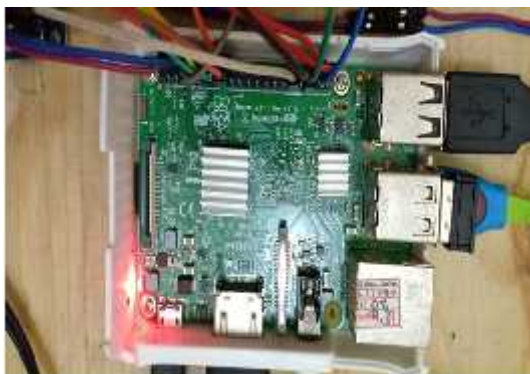
Gambar 7. Raspberry Pi 3 pada Maket Rumah Pintar
