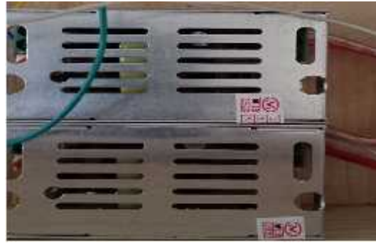
Gambar 10. Power Supply 5 Volt pada Maket Rumah Pintar
