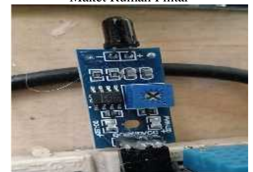
Gambar 16. Sensor Api pada Maket Rumah Pintar
