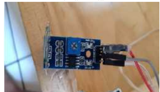
Gambar 14. Sensor Reed Switch pada Maket Rumah Pintar
