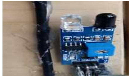
Gambar 12. Sensor Infrared pada Maket Rumah Pintar
