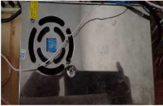
Gambar 9. Power Supply 220 Volt pada Maket Rumah Pintar
