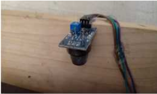
Gambar 17. Sensor Gas pada Maket Rumah Pintar
