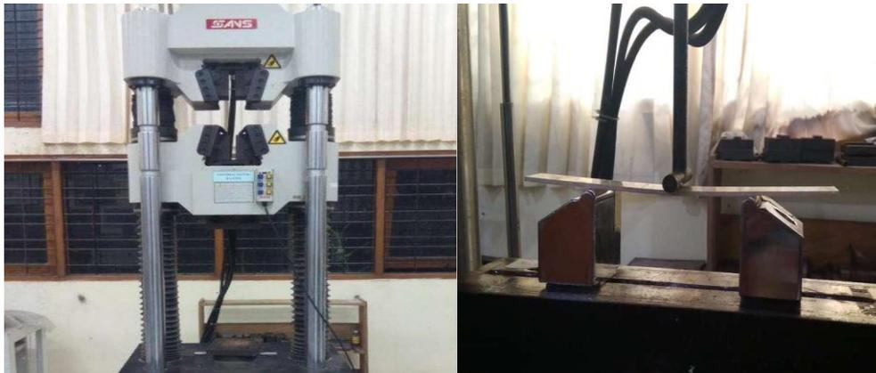
**Gambar 3** Pengujian Tarik dan Bending
