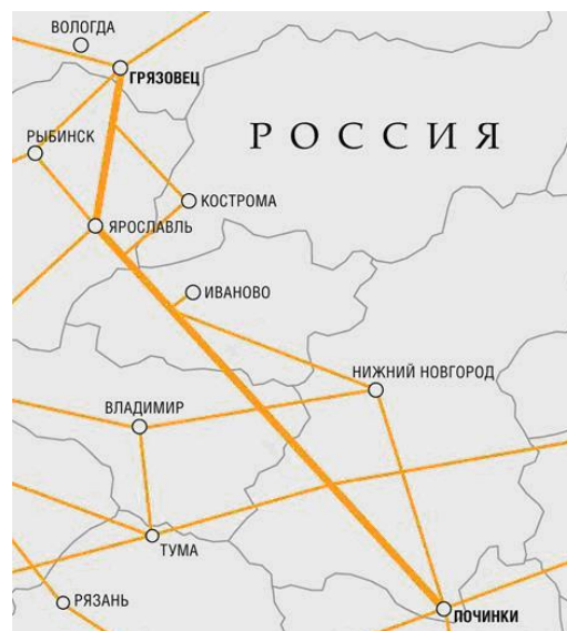
Рис. 1. Трасса газопроводной системы Починки–Грязовец среди административных областей РФ. Толстые и тонкие оранжевые линии – трубопроводные трассы разного класса, связанные друг с другом для бесперебойного снабжения углеводородами центральной части Европейской России
