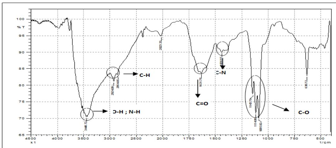
Gambar 1 Spektrum FTIR membran elektrolit Kit-PVA-Li-Kaolin-1
