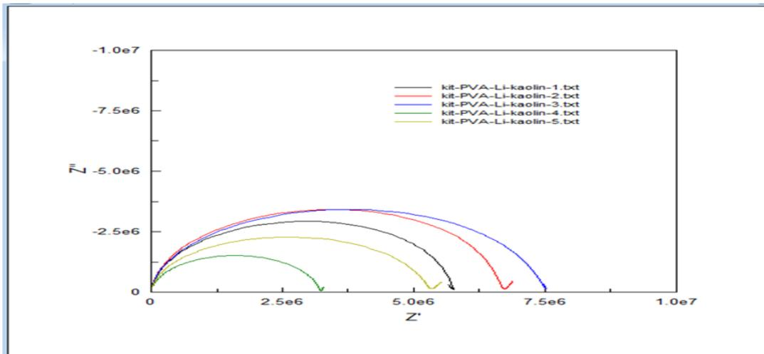
Gambar 6 Kurva impedansi membran kitosan-PVA-litium pada penambahan kaolin 1-5%.
