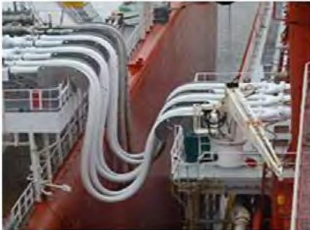
Gambar 2. 4 Unloading unit (Flexible Hose) untuk bongkar muat LNG dari truk dan kapal (Sumber: Heery Z, 2012))
