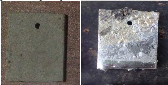
Gambar 4.1. (a) Spesimen Uji Sebelum dicoating (b) Spesimen Uji Setelah dicoating
