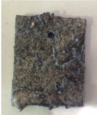
Gambar 4.10 Kondisi Visual Spesimen setelah Uji Korosi
