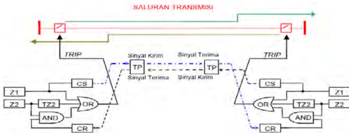
Gambar 2.11 Rangkaian logika skema PUTT
