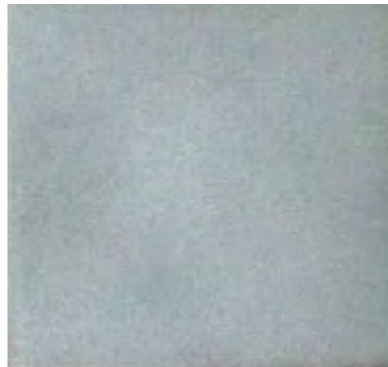
Gambar 0.2 . Hasil Blasting dengan material abrasif aluminium oxide dengan tingkat kebersihan SA 3
