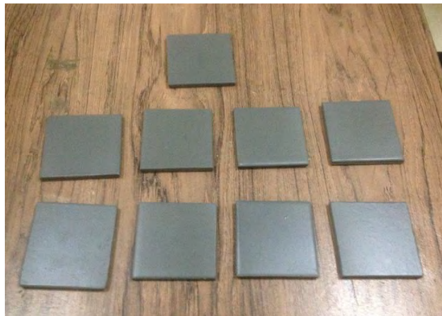
Gambar 0.9 Material yang di coating menggunakan cat primer epoxy
