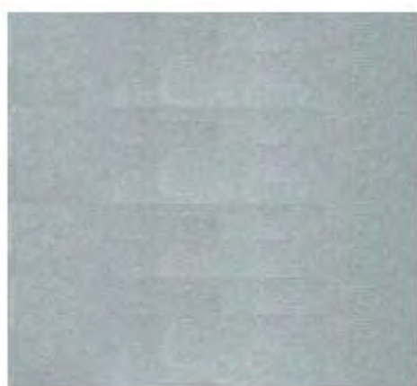
Gambar 0.7 Inspeksi visual hasil Blasting dengan material abrasif Volcanic Sand
