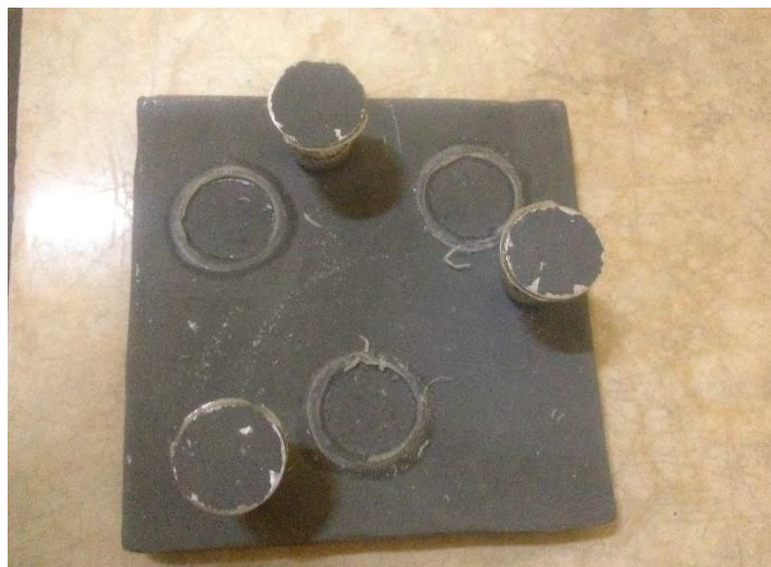
Gambar 0.13 Spesimen yang telah di pull-off
