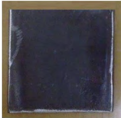
Gambar 0.1 Spesimen A-36 sebelum di Blasting
