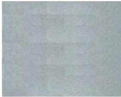
Gambar 0.4 Hasil Blasting dengan material abrasif Volcanic Sand dengan tingkat kebersihan SA 3
