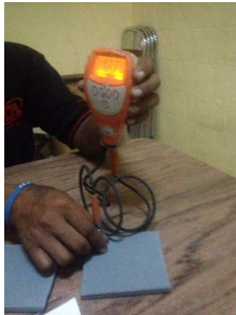
Gambar 0.8 Proses Pengukuran DFT
