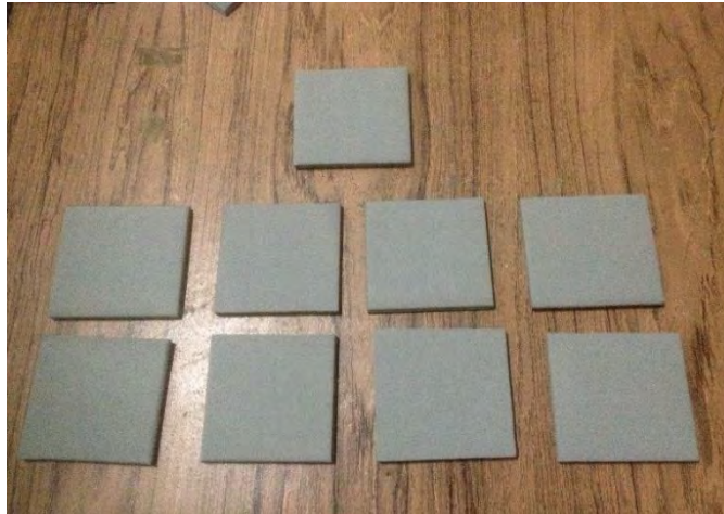
Gambar 0.10 Material yang di coating menggunakan cat primer zinc rich
