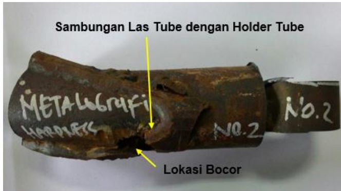
Gambar 3.2 Komponen riser wall tube yang mengalami kerusakan
