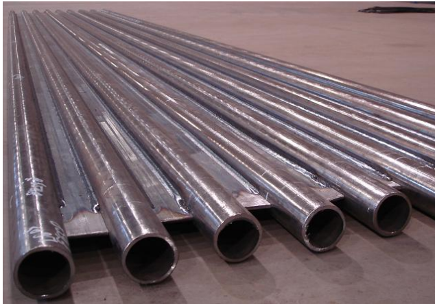
Gambar 2.2 Riser wall tube yang belum terpasang pada boiler (Ken Heselton, 2014)
