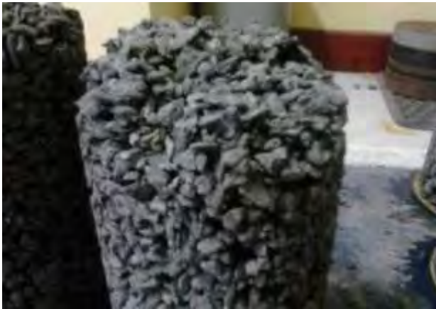
Gambar 4.5 Sampel C1 yang Tidak Dapat Diuji
