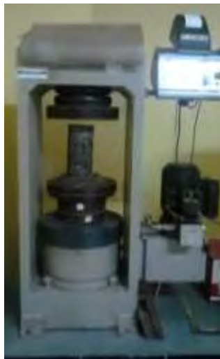
Gambar 4.3 Pengujian Kuat Tekan Beton Berpori
