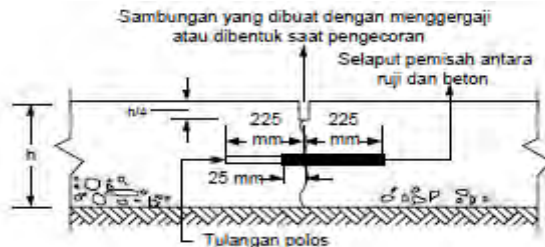
Gambar 2.7 Sambungan susut
