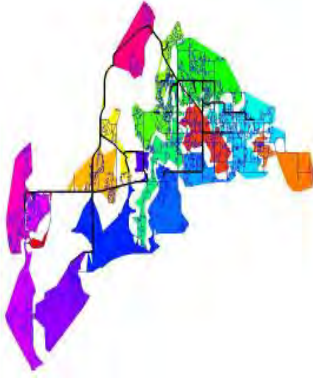
Desain DMA Menggunakan Fast-Greedy Algorithm (Sumber: Scibetta et al. , 2014)
