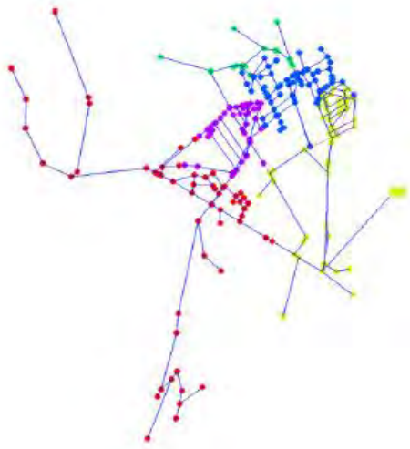
Gambar 4.9 Pembentukan DMA Berdasarkan Graph Theory dan Multi-Objective Algorithm (Sumber: De Paola et al. , 2014)
