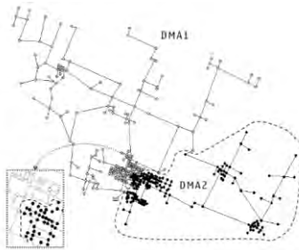
Gambar 4.5 Peletakkan Meter Air DMA menggunakan Metode Global Gradient dan Optimisasi (Sumber: Alvisi dan Franchini, 2015)
