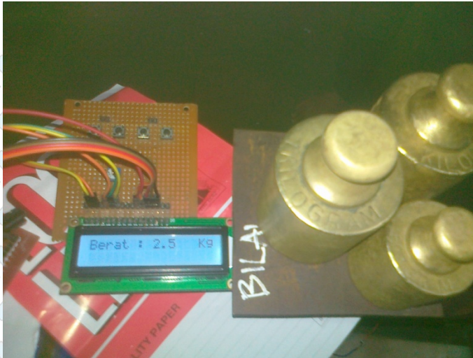
Gambar 4.11 Pengujian Berat Beban Pada Saat 2,5 Kg
