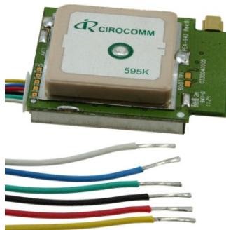
Gambar 2.4 Parallax GPS Module PMB-688 Beberapa fitur yang diberikan oleh modul GPS ini adalah :
