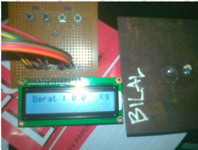
Gambar 4.10 Pengujian Berat Beban Pada Saat 0 Kg
